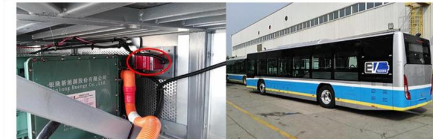
图 31：及安盾热气溶胶自动灭火装置应用于福田汽车电池内舱
