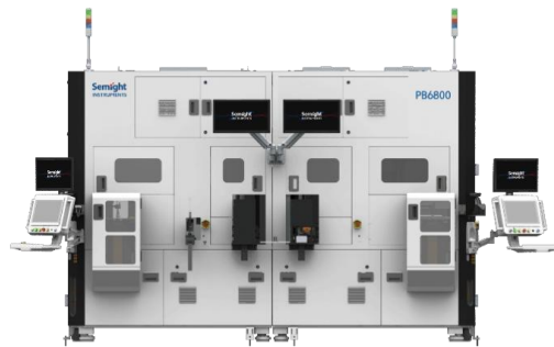
图表 29：功率芯片 KGD 分选测试系统
