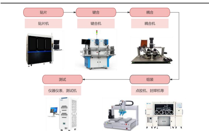
图 18：光模块封装制造全流程及核心设备示例
