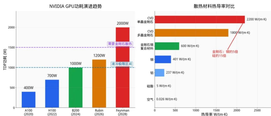
图表42：NVIDIA GPU 功耗演进趋势与散热材料热导率对比
