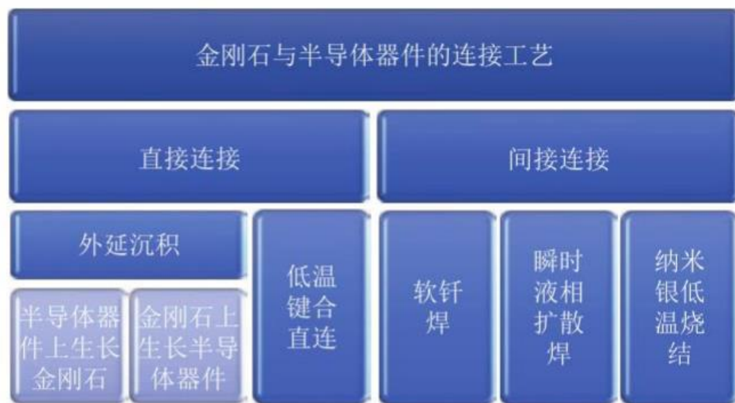
图表30：现有金刚石与半导体器件连接工艺的技术路线
