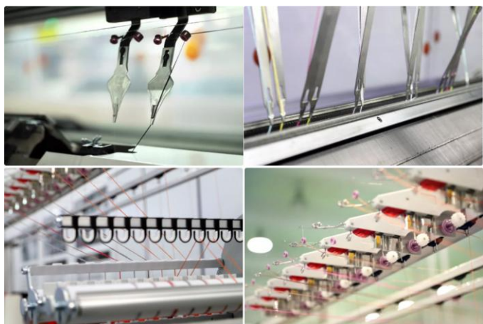
图表25：一线成型横机纱嘴工作过程
