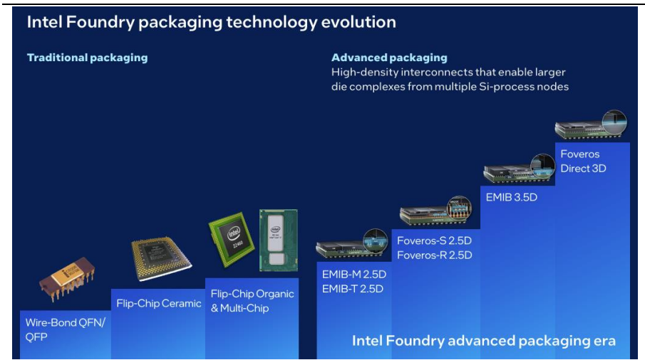
图 17: Intel 先进封装技术路线图
