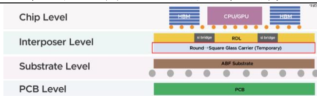
图 28: CoPoS 第一阶段预计采用临时玻璃基板解决成本产能与集成问题
