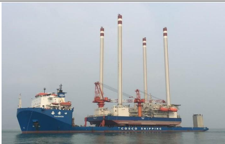
图29、正在运输大型海上风电平台的“泰安口”半潜船
