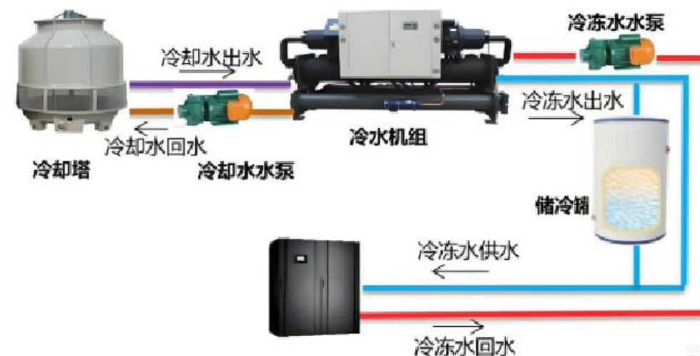
图表：冷水机组的冷冻水循环与冷却水循环
