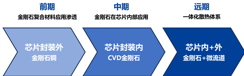
图表：金刚石复合材料与纯金刚石技术路线预计将同步发展
