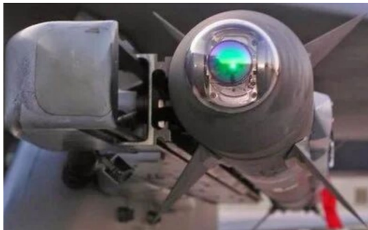
图表：金刚石可用于制造导弹制导光学窗口
