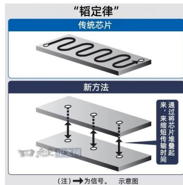
图表：华为韬（τ）定律的3D堆叠或将带来散热难题
