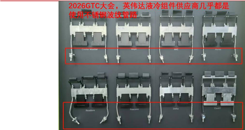
图5：英伟达 Rubin 服务器液冷方案采用不锈钢波纹管
