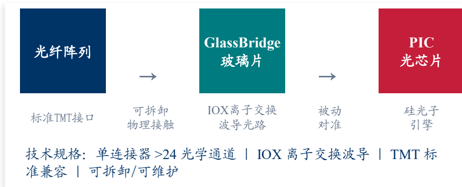
图：康宁（Corning）玻璃桥方案核心原理示意图
