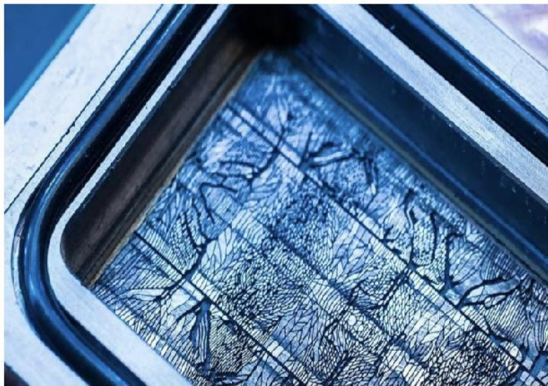
图12：硅片上刻有通道，允许冷却液直接流向芯片
