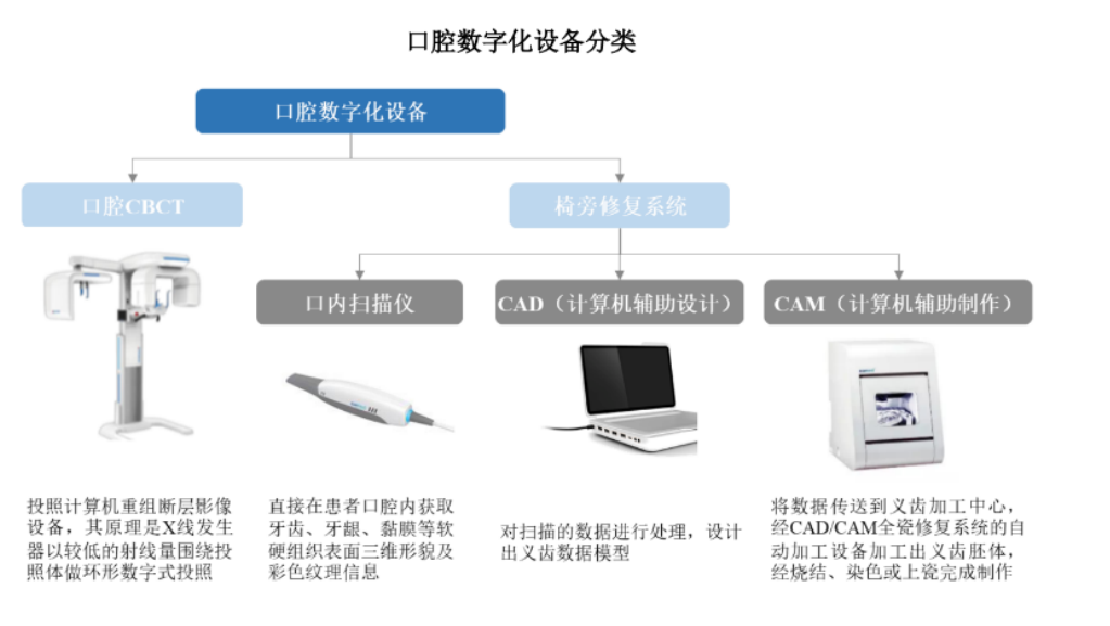
图27：口腔数字化设备包括口腔 CBCT 和椅旁修复系统
