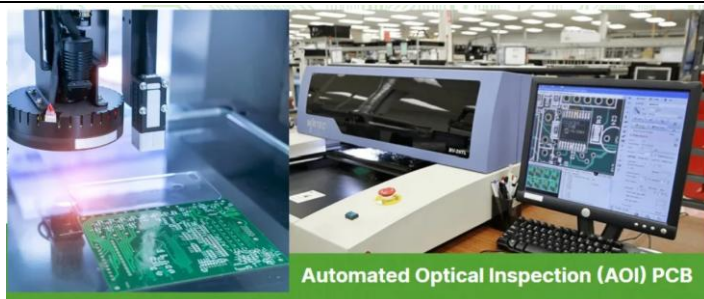
图 33：自动 AOI 光学检测
