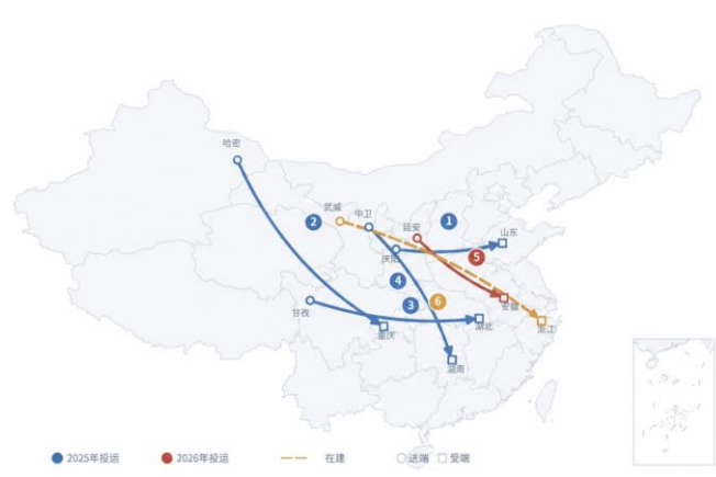
图13：“十五五”特高压工程连接西部新能源基地与东中部负荷中心
