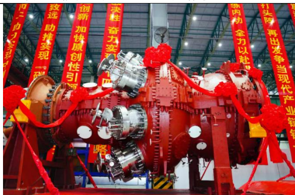
图 37：东方电气国产 F 级 50 兆瓦重型燃气轮机
