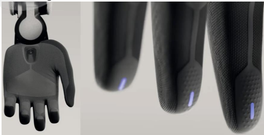
图表 55：Figure 03 灵巧手掌部摄像头示意图
