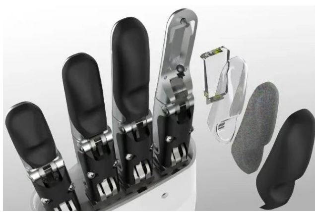
图表 54：戴盟机器人 DM-Hand1 视触觉灵巧手内部示意图
