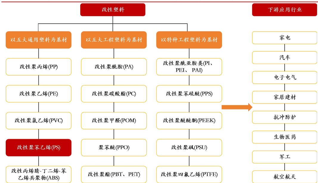
图表 20：塑料改性以五大通用塑料、五大工程塑料及特种工程塑料为基材
