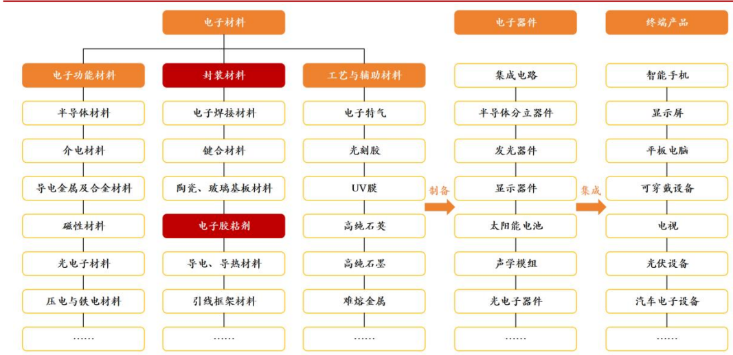
图表 11：电子封装材料及电子胶粘剂在电子产业链中的位置图示
