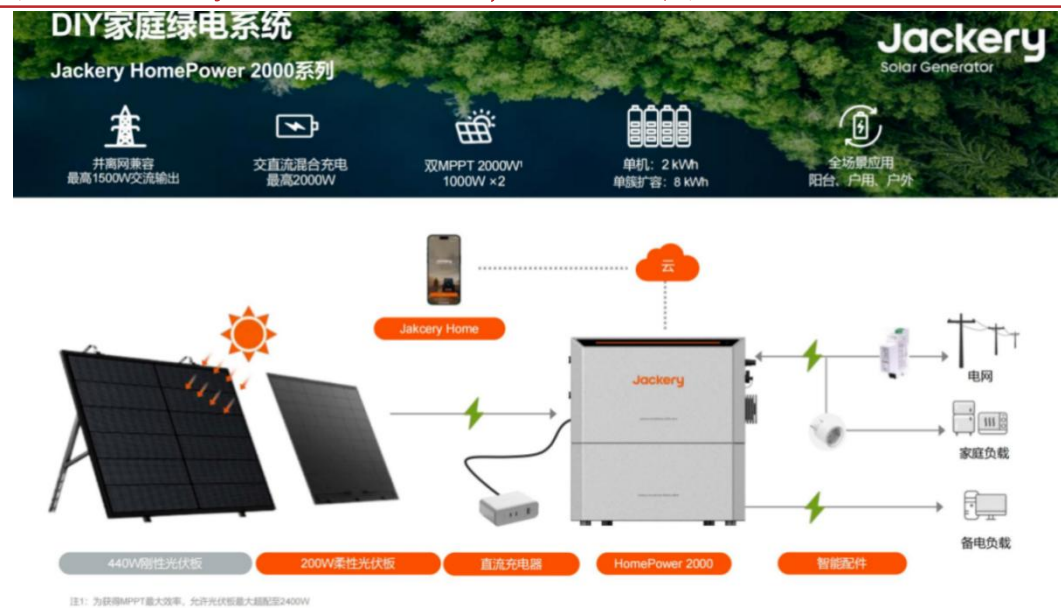
图表 1：以 Jackery HomePower 2000 为例，阳台光储工作原理示例
