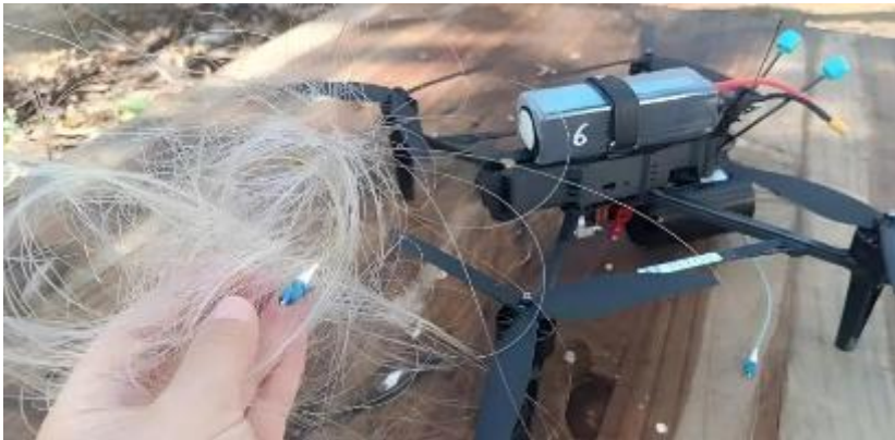
图：俄乌战争中使用的无人机搭载光纤
