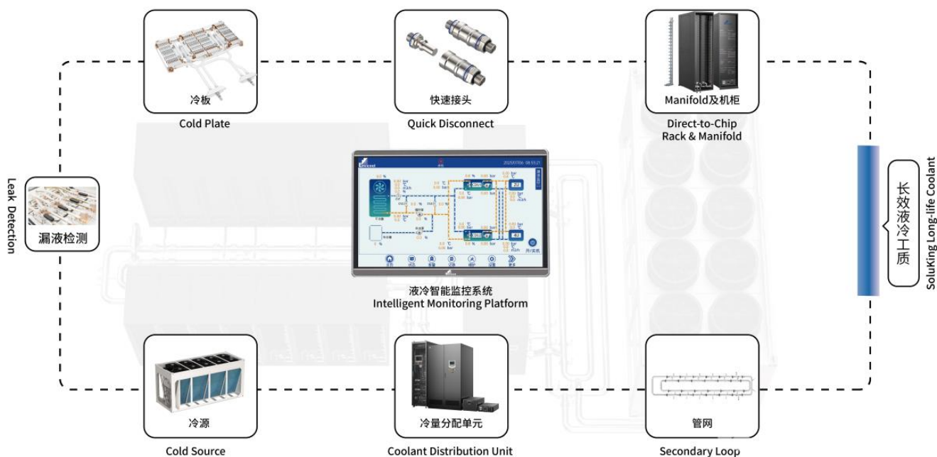
图11：数据中心液冷全景图
