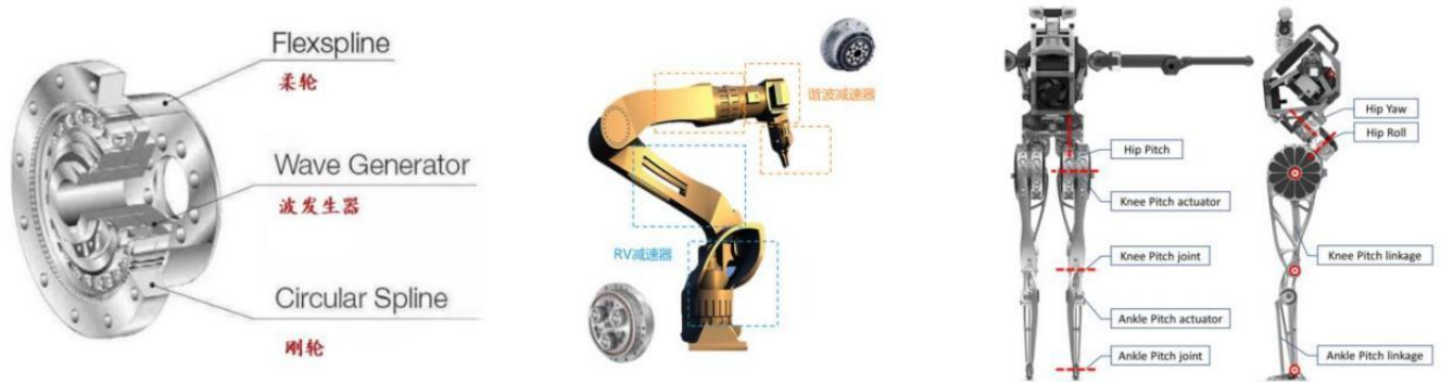
图25：谐波减速器结构示意图（左）、谐波减速器在工业机器人中的应用（中）、UCLA 人形机器人 ARTEMIS 关节中的减速器（右）
