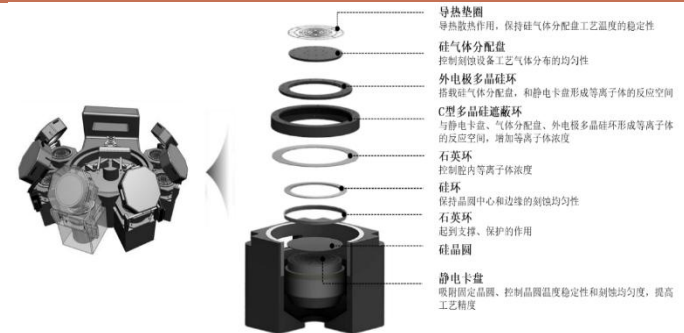
图 13: 硅零部件在 CCP 刻蚀设备反应腔内的应用情况
