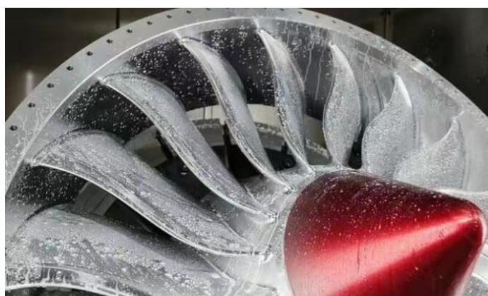
图49. 3D 打印航空发动机叶轮（风扇叶片组件）
