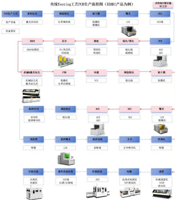
图 41：典型 PCB 生产工艺流程图
