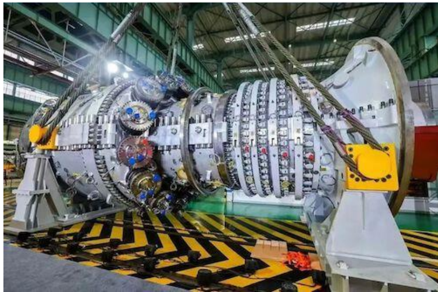
图 34：我国自主研发的 300MW 级 F 级重型燃气轮机
