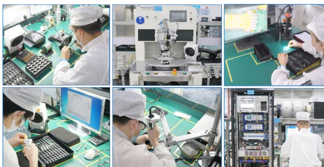
图表22：传统光模块制造环节大量依赖人工
