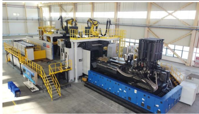
图 14: 海天智胜金属 HMG7000U 镁合金注射成型机
