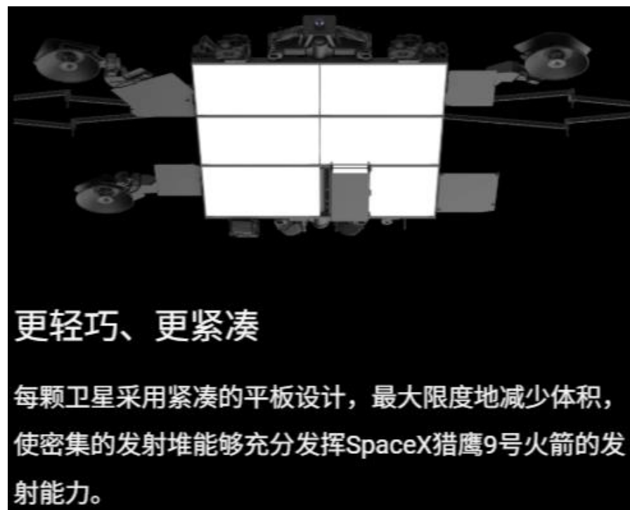
图表39: Starlink 堆叠式结构示意图
