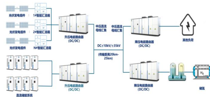
图 11：SST 在绿电直流中的应用
