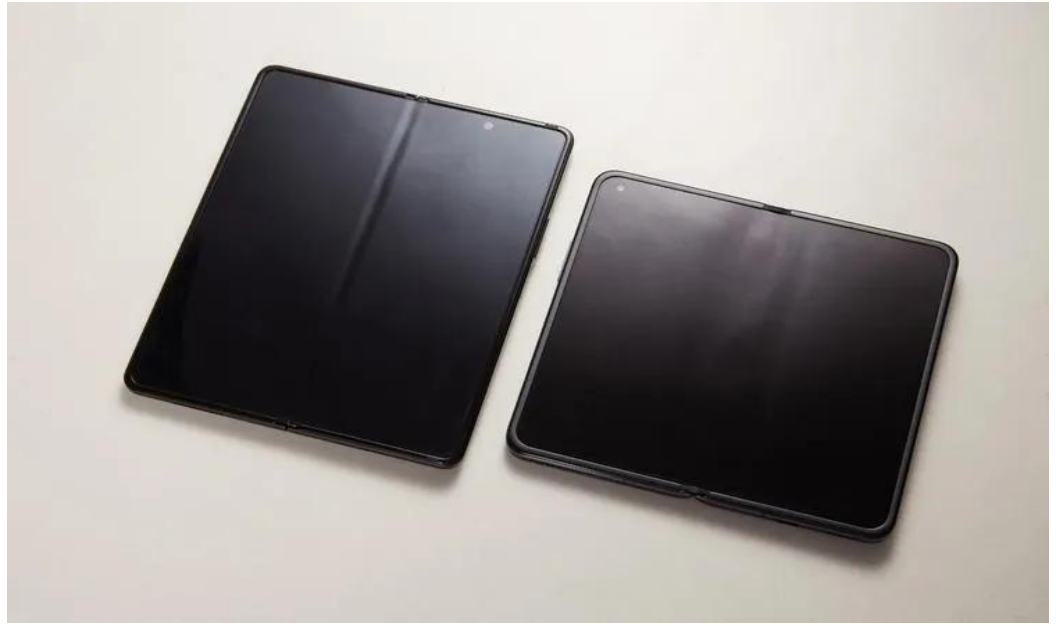
图 20：U 型铰链和水滴型铰链折痕对比
