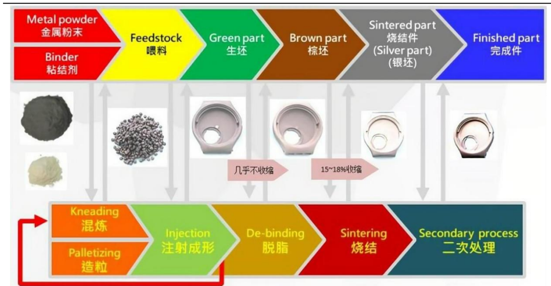
图 22：金属注射成形生产过程
