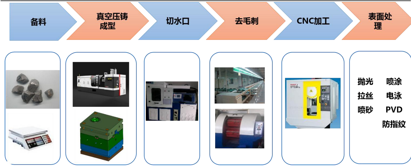
图 24：块体非晶结构件的生产工艺流程
