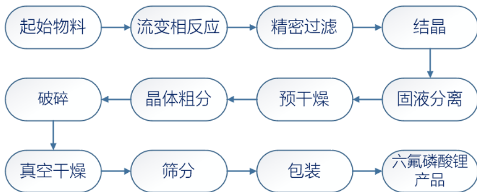
图 18：公司六氟磷酸锂生产流程
