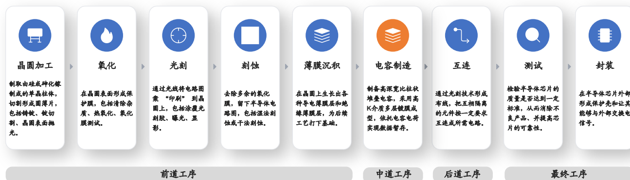
图2：存储单元制造为DRAM生产工艺核心环节
