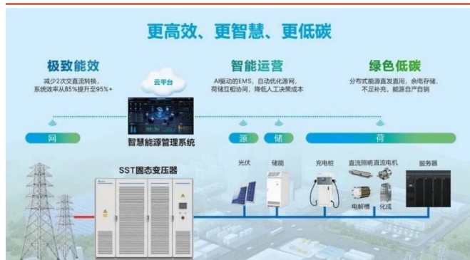
图 11：台达 SST 源网荷储一体直流化解决方案
