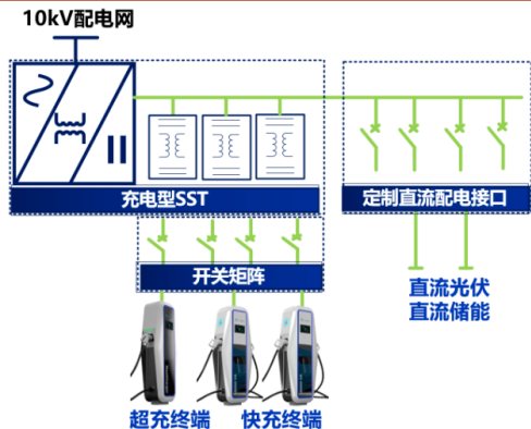
图 9：电动汽车充电 SST 直挂解决方案架构
