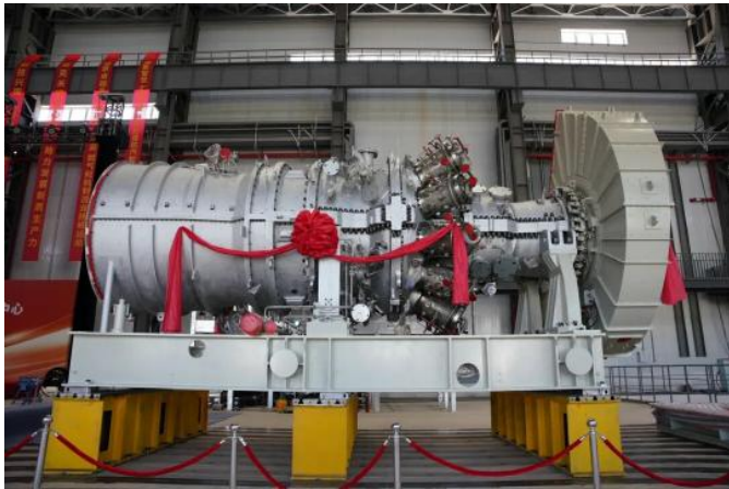
图表34: 杭州汽轮动力集团自主研发的 F 级 50 兆瓦重型燃气轮机 HGT51F
