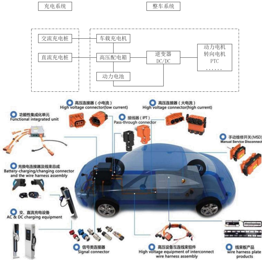
图：新能源汽车连接器分布示意图
