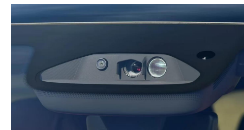
图、华为896线双光路激光雷达
