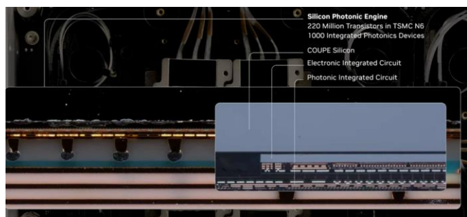
图表19: EIC采用台积电 N6 制程, PIC 与 EIC 采用 COUPE 技术封装
