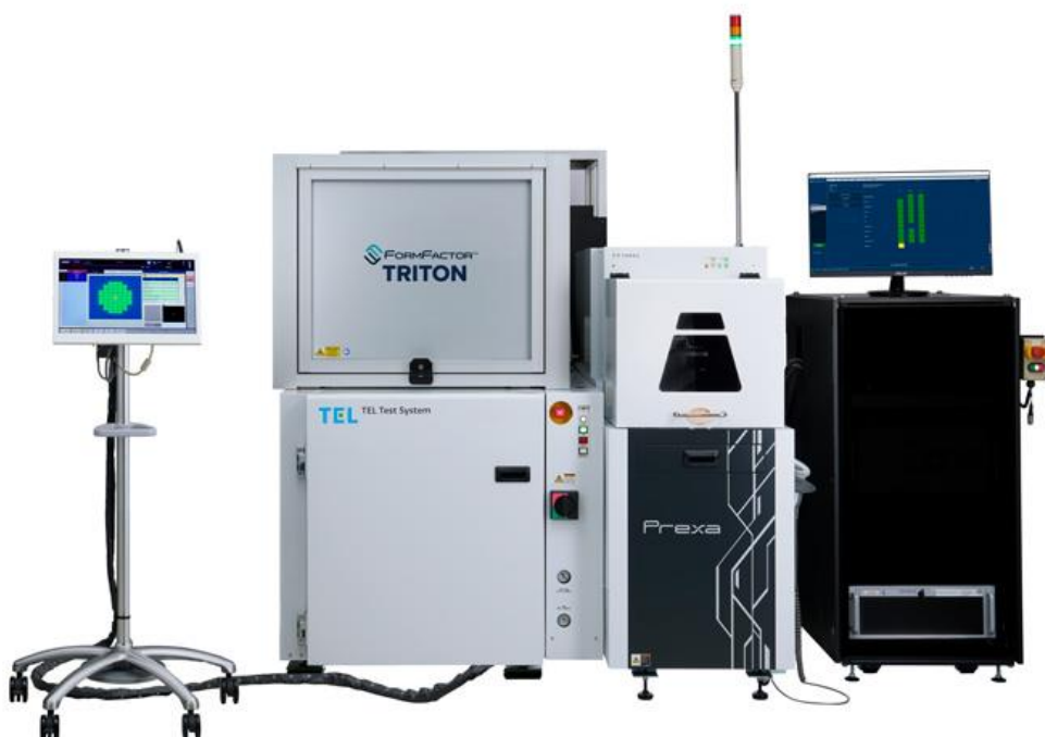
图表42: Formfactor、Advantest、东京电子合作开发的 CPO 测试系统，采用 Formfactor 高密度探针卡、Advantest 9300 测试机
