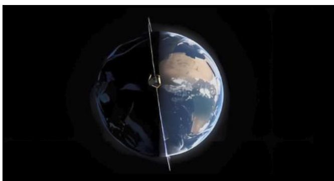
图表22：太阳永久照明轨道示意图（全年跟随晨昏线）
