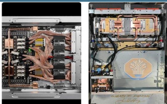
图表27: PCB 逐步代替铜缆
