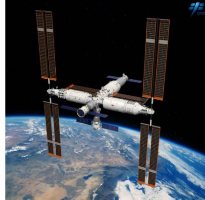
图 7：三结砷化镓电池柔性太阳翼应用于中国空间站
