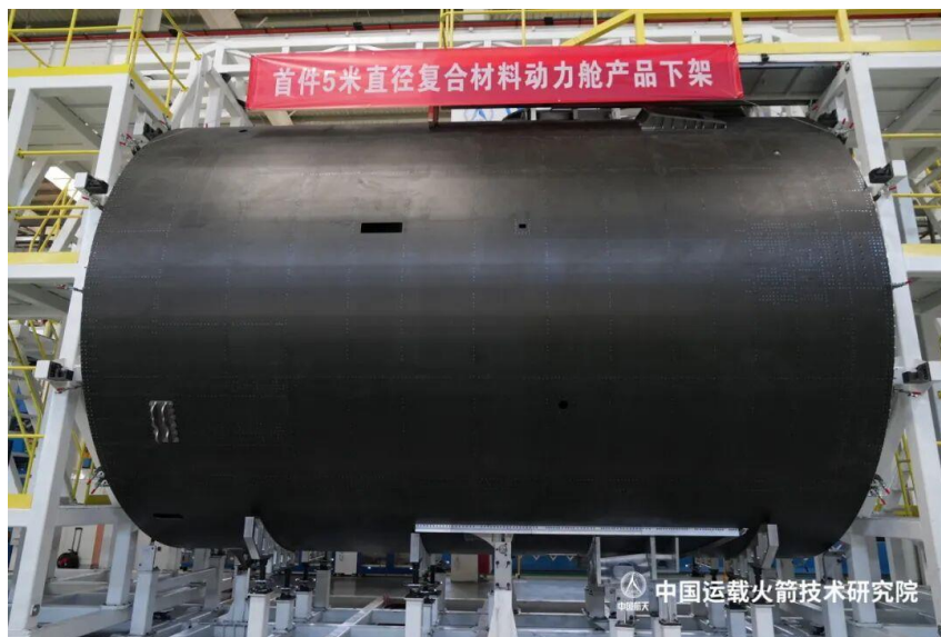
图：火箭院研制的首件5米直径复合材料动力舱产品正式下架
