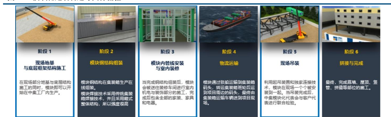
图 39：模块化建筑制造与交付流程
