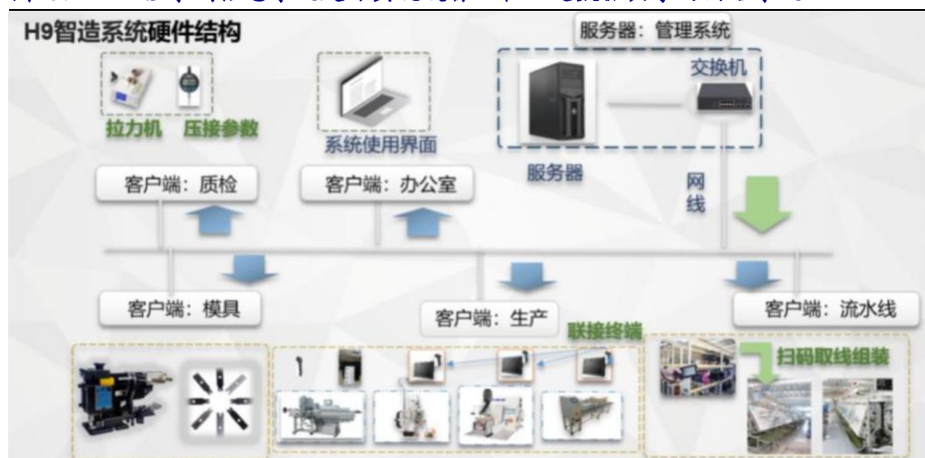
图20: HMES 系列信息系统是可实现设备互联互通数据共享的网络系统
