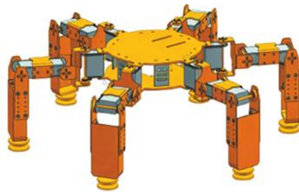
图 36：一种安装红外线摄像头和声波盘的足式管道机器人
