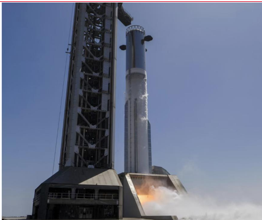
图表13：SpaceX V3 版本星舰静态点火测试
