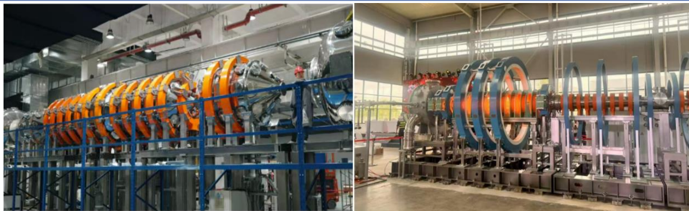
图16：星能玄光反位形(FRC)直线型装置 FLAME（左）、瀚海聚能直线型场反位形聚变装置 HHMAX-901（右）
