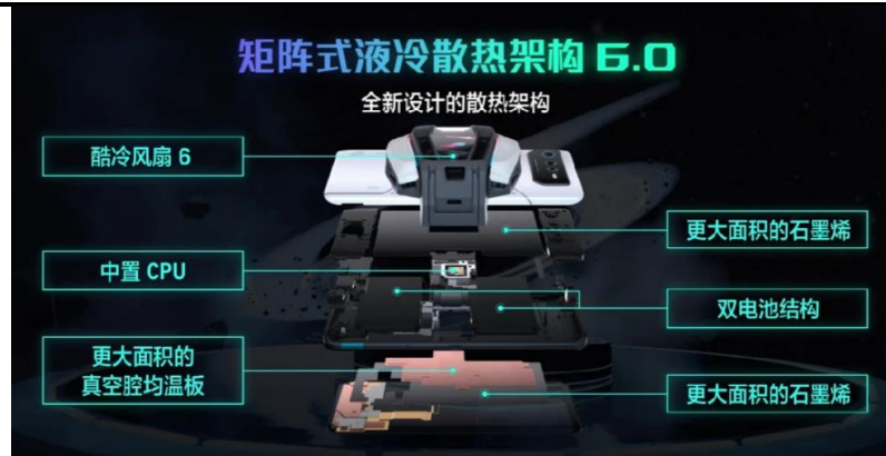
图 15：腾讯 ROG 游戏手机 6 系列矩阵式液冷散热架构示意图
