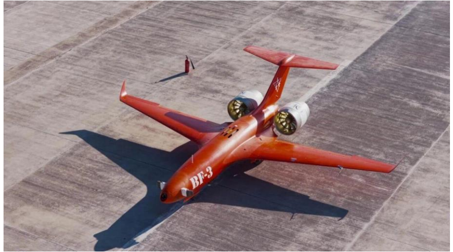
图4: 60 千瓦混合动力电推进已完成飞行演示验证
