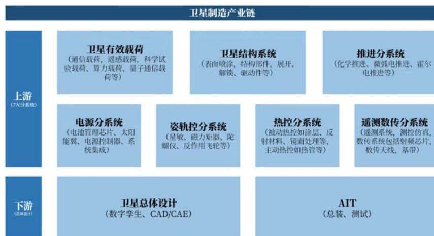
图 3：卫星制造七大子系统组成
